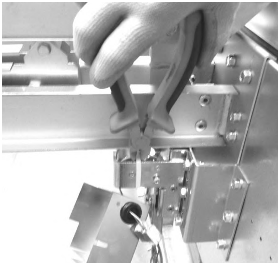
Rys. 46 Przecinanie opaski zaciskowej w celu odbezpieczenia zamka.
